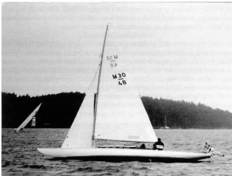
Vår båt är 11,5 meter lång, 2,06 meter bred och väger 2,450 kg
